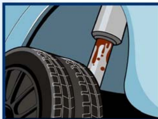
Öl am Stoßdämpfer (Ein leichter Ölleak dient zur Selbstschmierung der Kolbenringe)
