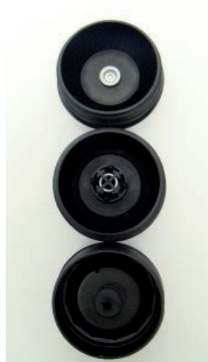
Bild 2: Ölfilter, Ansicht von innen: drei unterschiedliche Anschraubdeckel
