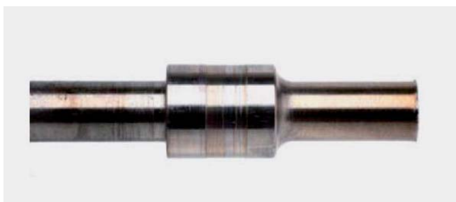
Abbildung 2: Deutliche Verschleißspuren auf der Welle an der Lagerstelle
