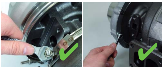
Abbildung 2: Spannschellen und Schrauben dürfen zur Justage gelöst werden
