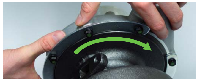
Abbildung 3: Gehäuse kann durch Verdrehen an die Einbaulage angepasst werden
