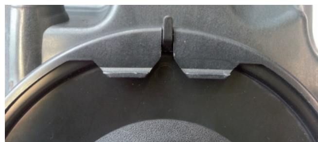
Bild 1: Die von MAHLE entwickelte Ausrichtkontur an der Endscheibe gewährleistet die korrekte Ausrichtung des Filterelements und damit eine präzise Luftmassenmessung.
