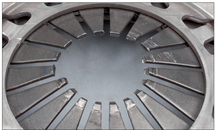
Bild 1: Defekte Tellerfeder durch fehlende Vorlast
