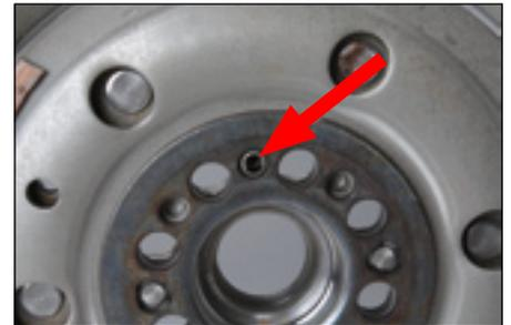
Bild 2: Paßbohrung im Zweimassenschwungrad auf der Kurbelwellenseite
