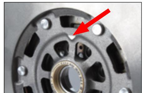
Bild 3: Kennzeichnung der Paßbohrung durch die dreieckige Markierung auf der Getriebeseite des Zweimassenschwungrades
