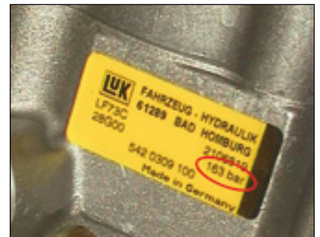
LuK Lenkhilfpumpe mit Druckbegrenzungsventil
