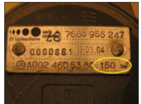
ZF Lenkhilfpumpe mit Druckbegrenzungsventil
