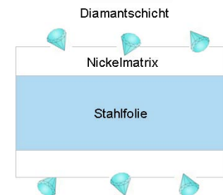
Verbaut wird die Diamantschleibe zwischen der Riemenschleibe und der Kurbelwelle.
