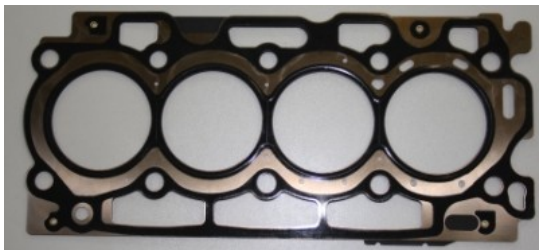
Dichtung für 1.6L Motoren (vorher auch für 1.4L Motoren)
