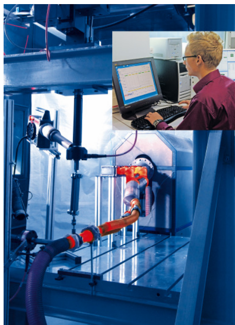
Prüfstand zur statischen und dynamischen Erprobung von Heißgasdichtungen, wie z. B. Turboladerdichtungen
