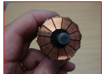
Schäden am Kommutator durch Verunreinigungen im System
