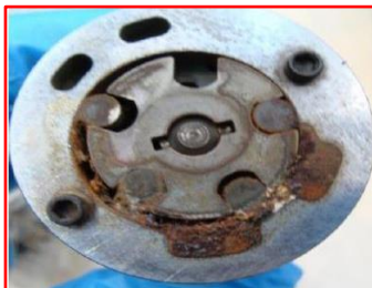
Oxidierungen auf der unteren Turbine
