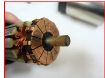
Oxidierungen auf der oberen Welle
